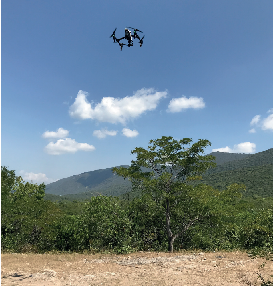
Figura 6. Vuelo de un dron Inspire 1 DJI con cámara térmica
